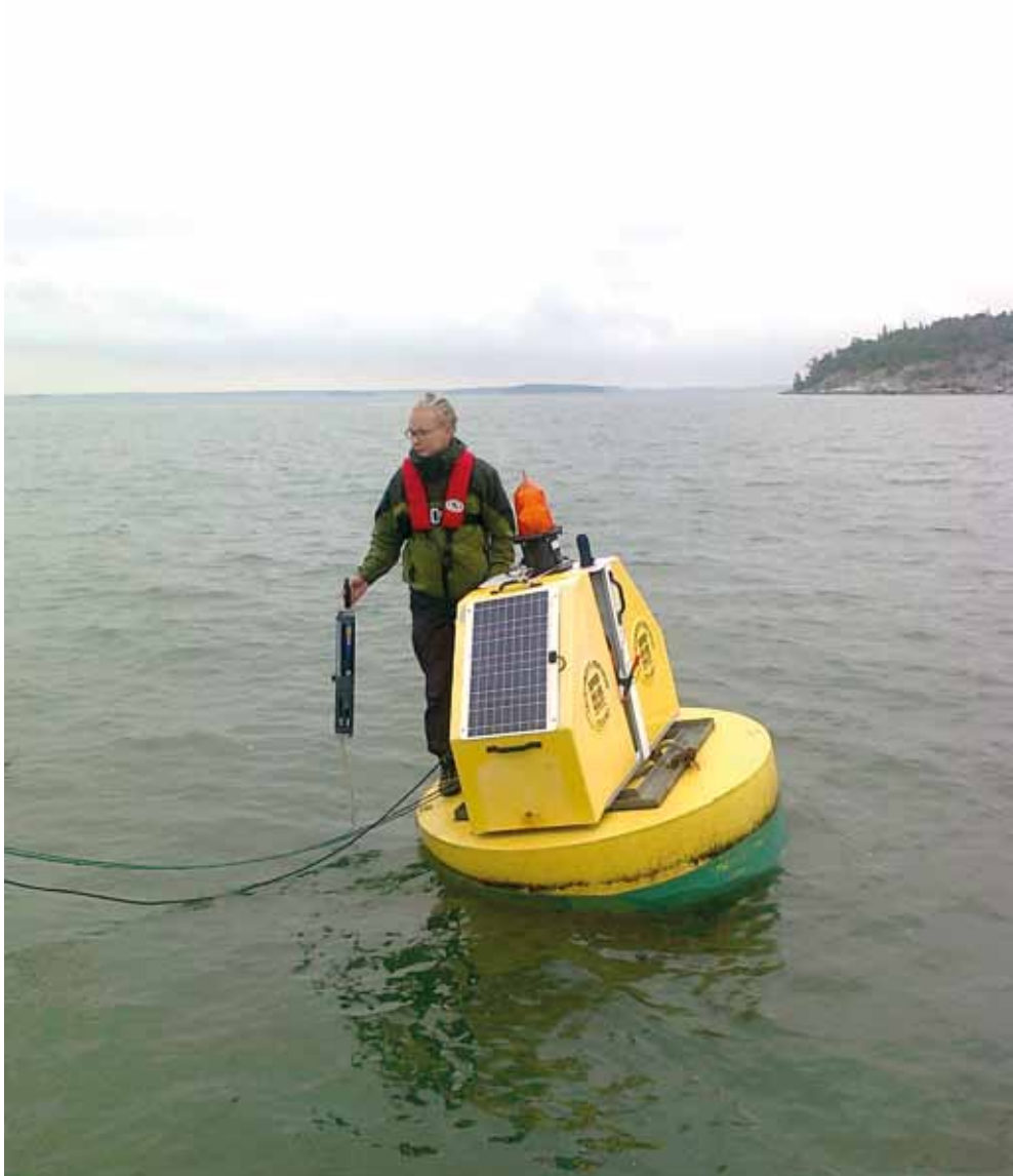
Saaristomeren virtaustutkimuksen virtausmittauspaikka numero 7 oli Päiväluodon luona. Siitä on alkanut yhtäjaksoisesti tehty aikasarjatutkimus meriveden suolapitoisuudesta ja lämpötiloista. ODAS-pojun luona kerätään nykyisin oseanografista tietoa useiden laitosten (SYKE, ely-keskus, IL, Ty ja turkuamk) yhteistyönä. Kuvassa turkuamk:n aloitteesta paikalla vuodesta 2006 ollut automaattinen CTD-poiju. Poijun tuottama data on nähtävissä on line verkkosivulla http://natureit.net/poiju/lamopotila . Kuva: Ilppo Vuorinen
