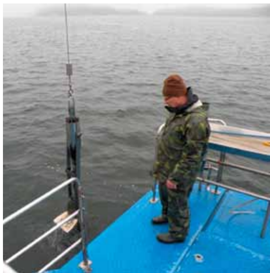
5. A) Merenpohjan näytteenottoa Aurelialta, ottimena Niemistö-noudin. Mukana näytteenotossa kurssin opettaja Joni Mäkinen. Kuva: Antti Rinne 2011
