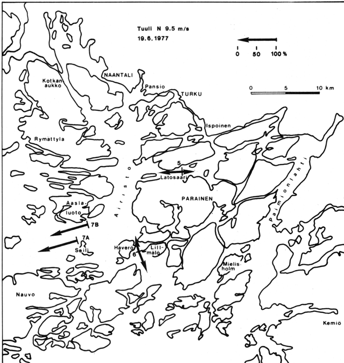
Pohjoistuulella ajautuu Airiston pintavesi etelään ja länteen. Korvaava vesi tulee paikalle pohjavirtausten myötä ja on myös selvästi suolaisempaa. Kuva: Virtaustutkimuksen neuvottelukunta 1976
