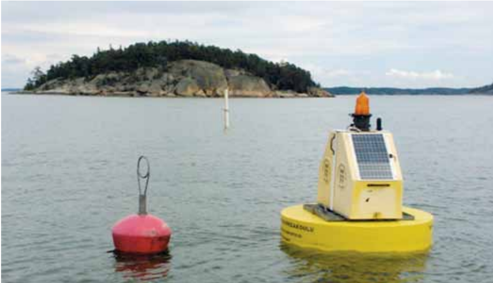
Virtausmittauksen tutkimuspisteellä 7A tekevät yliopiston lisäksi ympäristönseurantatutkimuksia Lounais-Suomen ely-keskus, Suomen ympäristökeskus ja turkuamk. Keskellä ODAS-poiju, edessä turkuamk automaattinen mittausasema. Kuva: Ilppo Vuorinen
