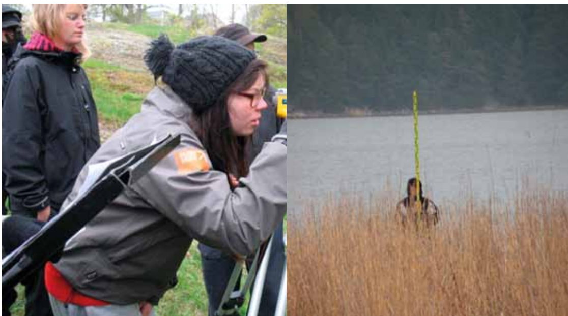
2. Rantavyöhykkeen profiilin mittaamista vaaitsemalla. Työn touhussa vaaituskoneen takana Anni Törhönen ja takana toimintaa seuraa Sofia Tuisku. Kuvat: Elsa Ruotsalainen ja Antti Rinne 2011
